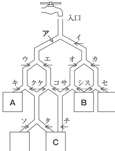
ア、イを流れる水の量、ウ～カを流れる水の量、キ～セを流れる水の量、ソ、タを流れる水の量はそれぞれ等しくなります。
